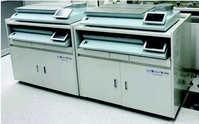
G210が一度に2台設置することが可能です。下段はソフトクローズ式のスライドレールが備わっており、全閉状態の時には、G210が飛びなさないよう、ロックされるように作られています。
